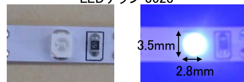
写真・下：青 幅10mm LEDチップ 5050
